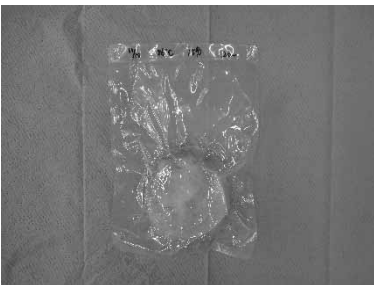
加熱殺菌処理前の真空包装状態
