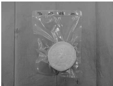
加熱殺菌処理前の真空包装状態
